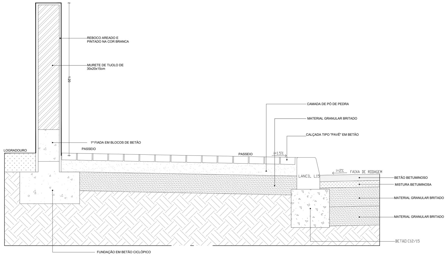
PORMENOR CONSTRUTIVO DO MURO E PASSEIO
